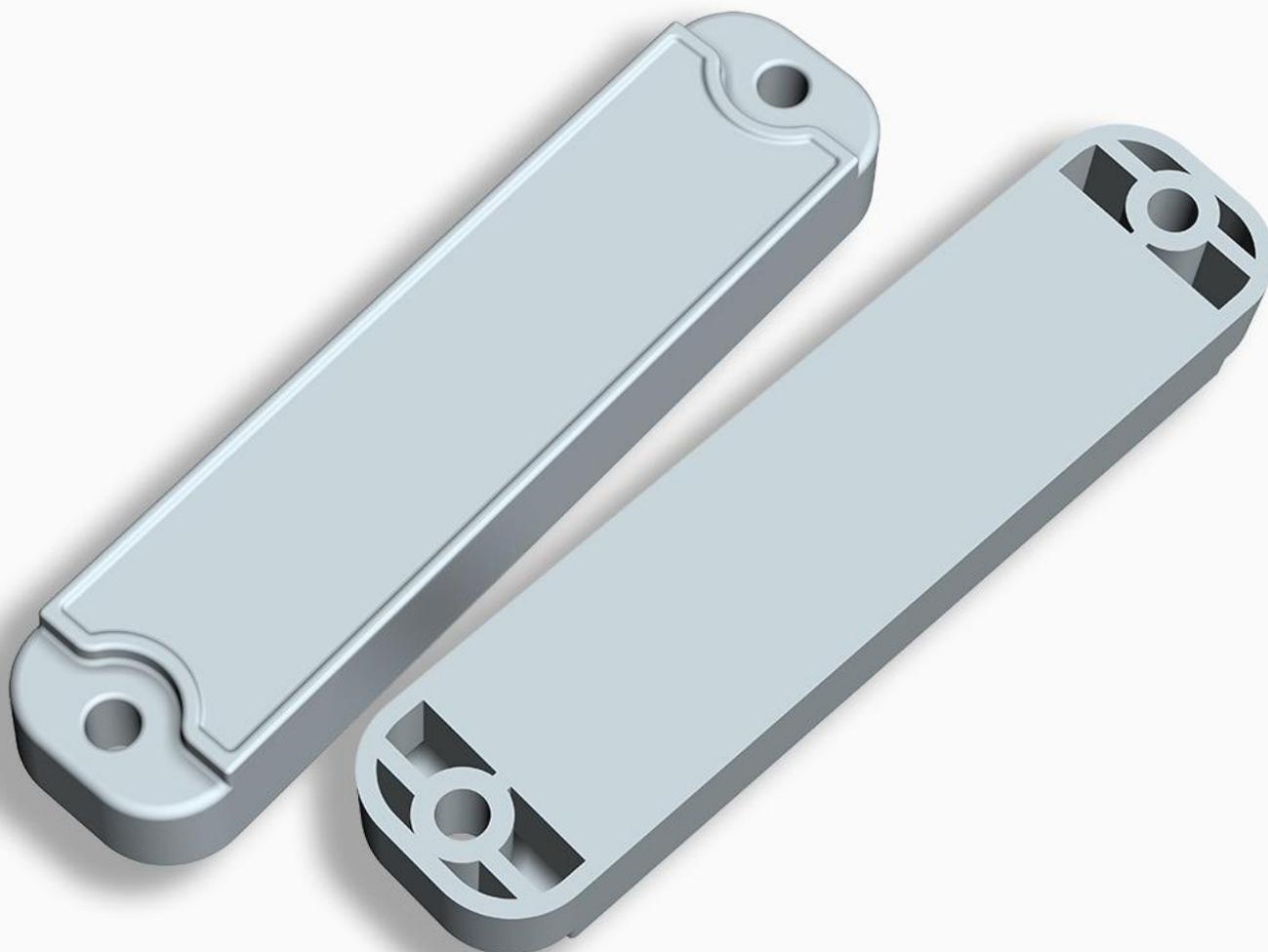
HT006 è un hard tag RFID in ABS, materia termoplastica dalle buonissime caratteristiche meccaniche: rigidità, durezza, resistenza agli urti e all'acqua. Dall'aspetto rettangolare, **questo tag è progettato appositamente per la gestione delle risorse industriali all'aperto**. Utilizzabile su superfici metalliche e non metalliche, **misura 85 x 20 x 11 mm** ed è applicabile tramite rivetto, avvitamento o adesivo. Disponibile **nella frequenza UHF**, sia
