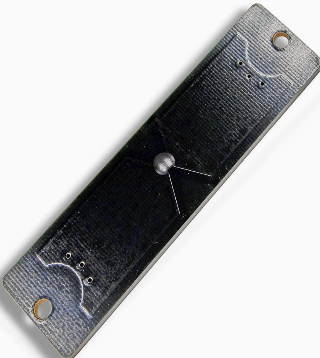
HT061 è un hard tag RFID in FR4 (*Flame Resistant*), materia composta essenzialmente da fibra di vetro e da resina epossidica ritardante alle fiamme. Con un'alta resistenza elettrica, questo materiale assorbe minimamente l'umidità. Inoltre, resiste alle sostanze acide e alcaline. Di forma rettangolare, misura 95 x 25 x 4 mm e pesa 15 grammi ed è **pensato per le applicazioni su superfici**
