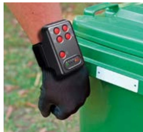
Discovery Mobile 3.0 legge il tag RFID sul bidone
